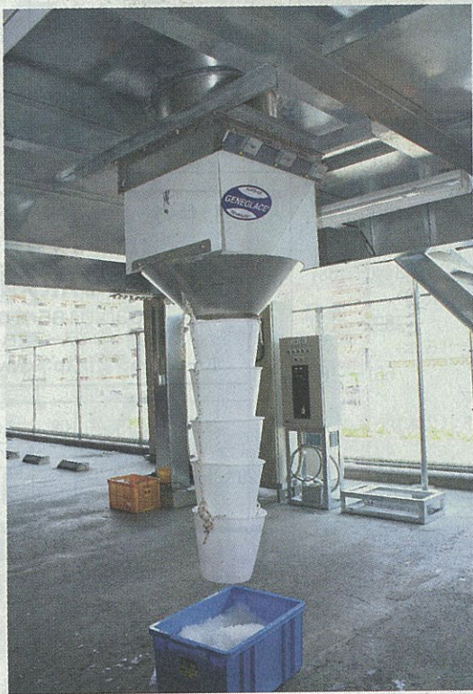
福水協事務所前に設置されたフレークアイス製氷機の供給部
